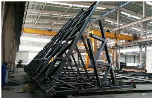
한국에서 철제 구조물을 사전제작한다. Steel frames made by prefabrication in Korea.
